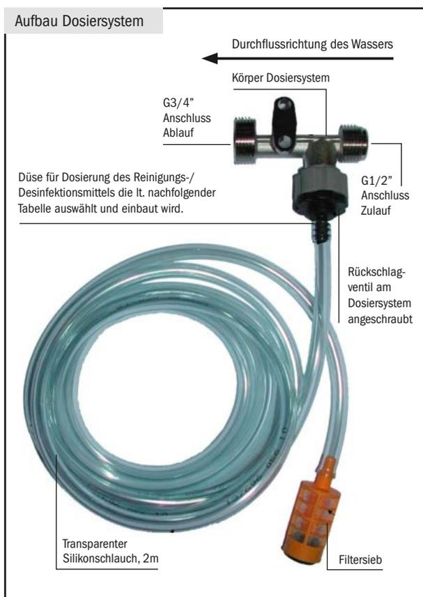
Die Dosierung von Reinigungs-/Desinfektionsmittels erfolgt mit Düsen unterschiedlicher Größen – im Lieferumfang enthalten (Abb. 18). Um die gewünschte Konzentration zu erreichen muss die entsprechende Düse ausgewählt werden (siehe nachfolgende Tabelle).
